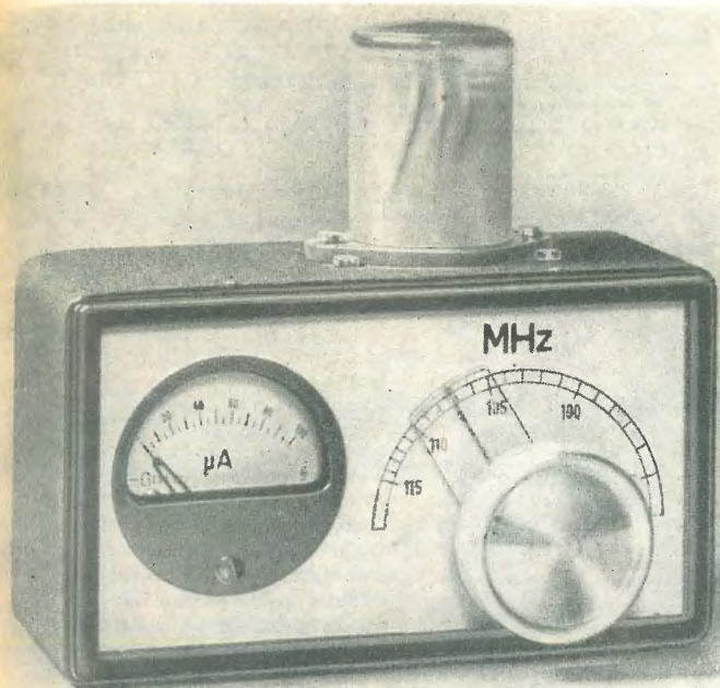
Fig. 1. - Veduta esterna. Campo di frequenza: da 95 a 115 MHz. Dimensioni: 140 x 80 x 60 mm.
